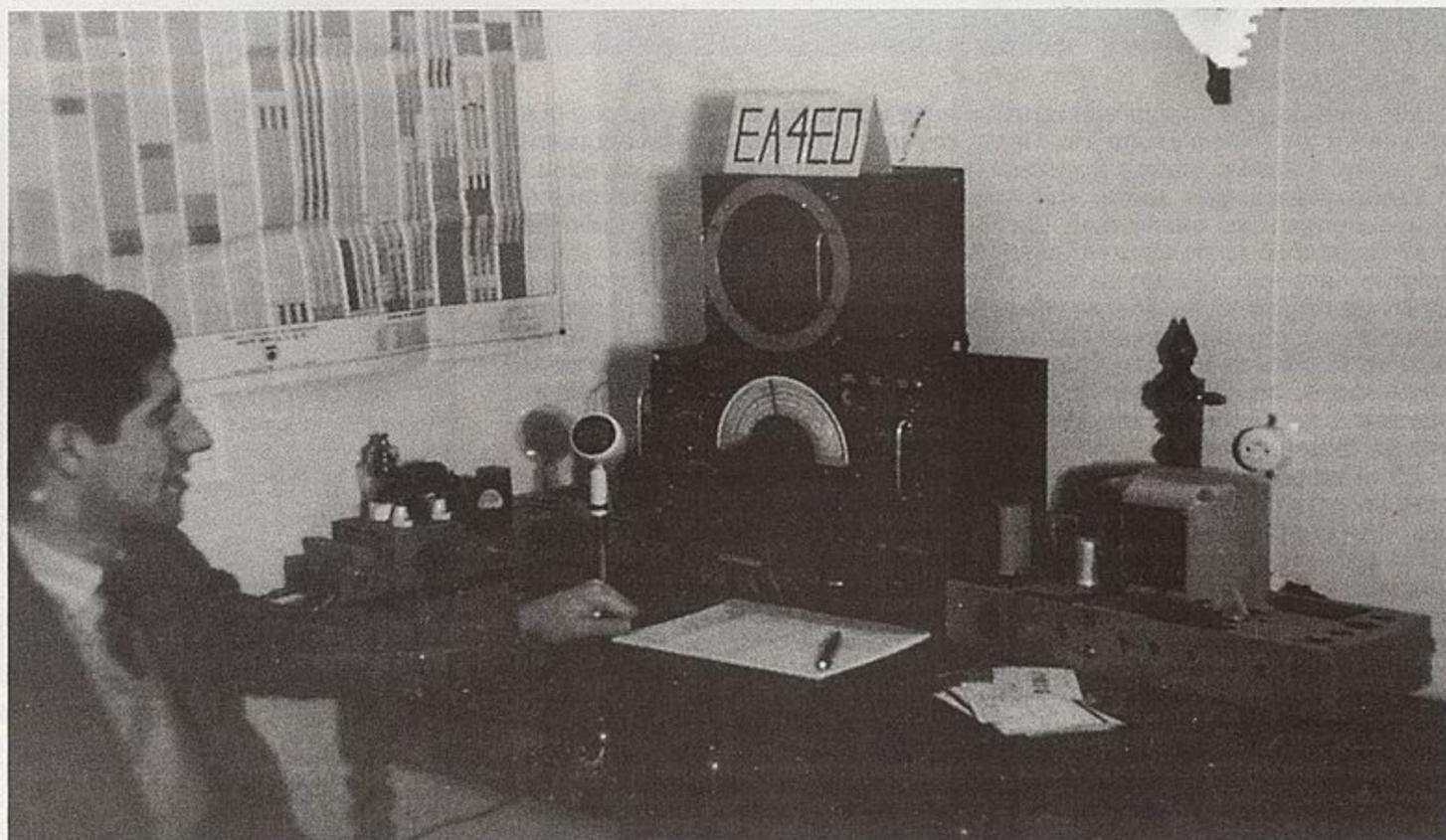
**EA4EO estrena estación e indicativo en julio de 1953. En el centro, un receptor de la RAF modificado por él. A la izquierda, el transmisor con una KT8 equivalente a la 807; a la derecha, la fuente de alimentación, ambos de construcción casera. En la pared, la tabla de distribución de frecuencias del Convenio de Atlantic City.**
