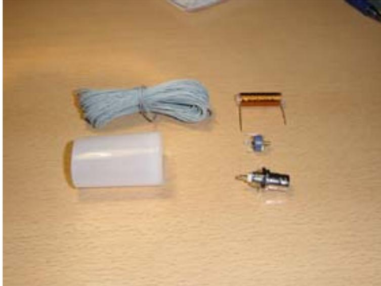
La longitud del cable de antena es de 1/2 onda para la frecuencia de trabajo. Con un factor de velocidad de 0.95 para el cobre y a una frecuencia de trabajo de 14.060 la longitud teórica es de **10.13 metros**. Yo siempre dejo 4 o 5 cm más para poder hacer un nudo en el extremo. Esta longitud extra tiene poco efecto en la resonancia y se compensa perfectamente por el adaptador de impedancias.
