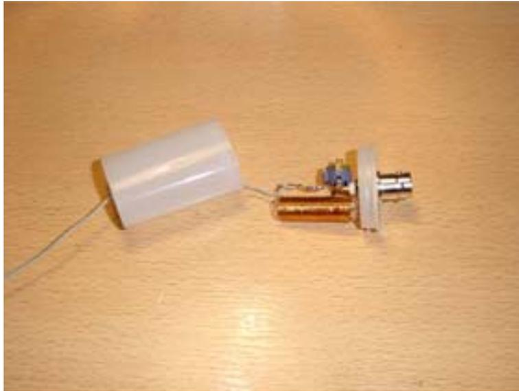
Comprobamos que cierre la tapa y la antena está terminada. Si es necesario realizar algún ajuste posterior sólo hay que soltar la tapa y retocar ligeramente el trimmer.
