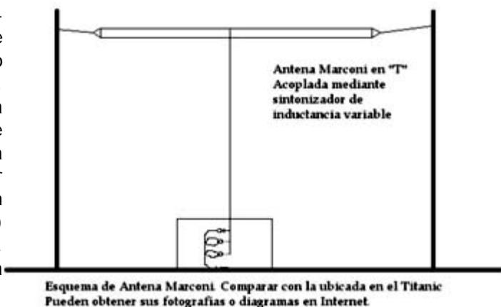
El cálculo de la frecuencia de resonancia de una antena Marconi en T es fácil de realizar si nos olvidamos por un momento de uno de los palitos horizontales de la
