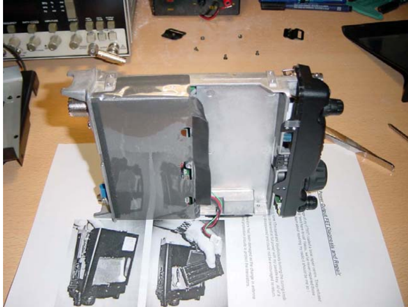
Foto1: Lámina de blindaje de la unidad de potencia.
