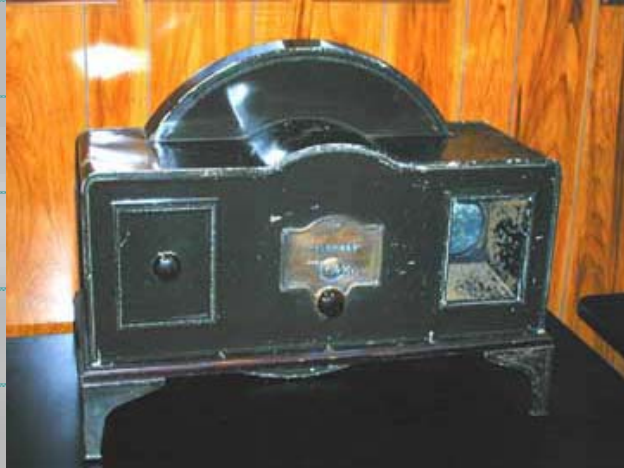
Disco de Nipkow Pantalla electromecánica de finales del Siglo XIX
