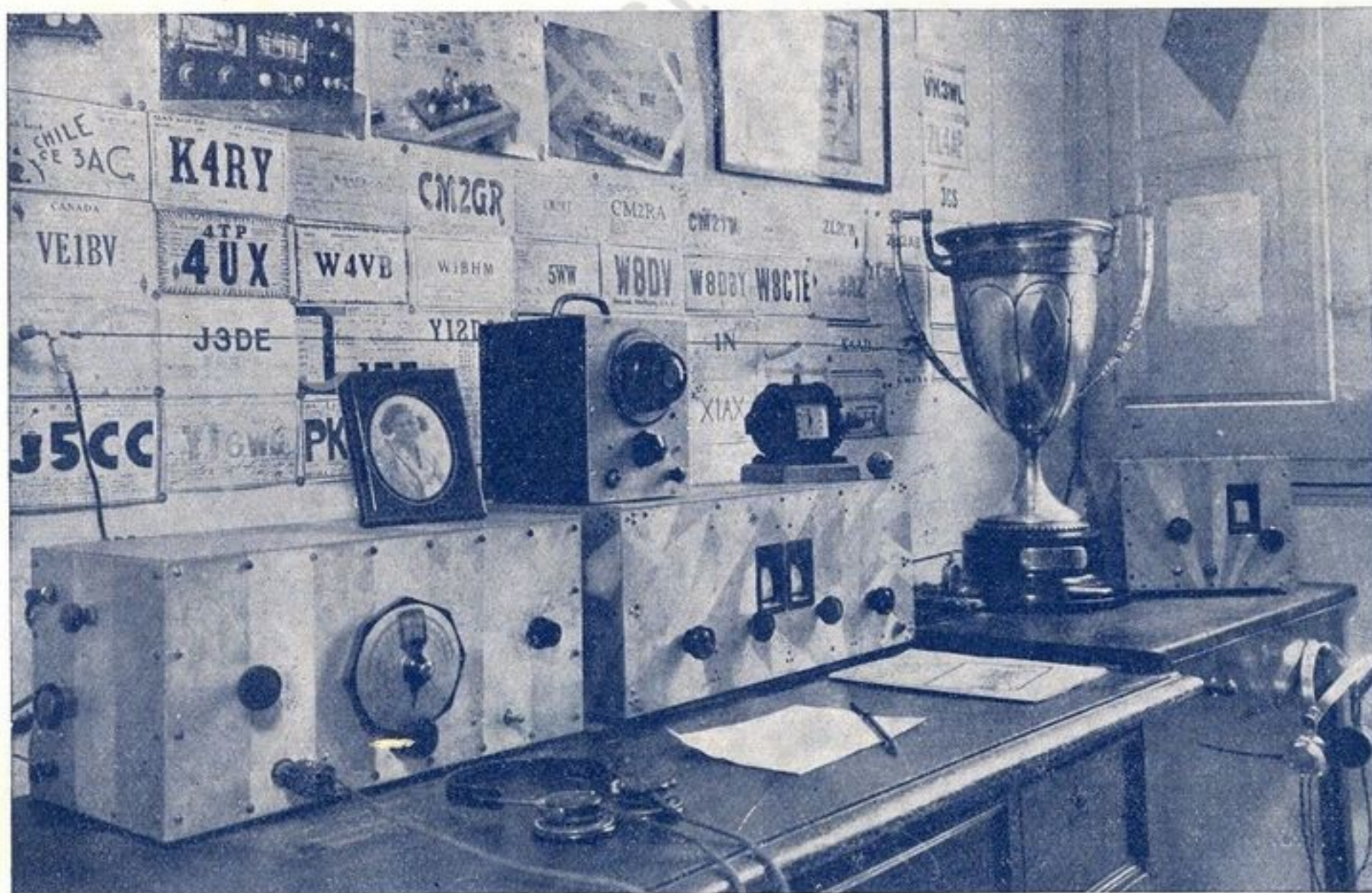
MESA DE RECEPCIÓN PARA ONDAS DE 5 A 200 M. Y MANIPULACIÓN DEL TRANSMISOR DE EAR 96. AL FONDO, LA «COPA DE ESPAÑA».
