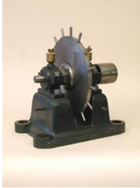
**Fig. 14.-** Disco descargador de la estación de Poldhu. Actualmente se conserva en el Museo Marconi. Es de acero, con un diámetro de 30 cm. Se accionaba por medio de una polea y giraba sobre casquillos de latón. Los dientes de la periferia son de latón.
