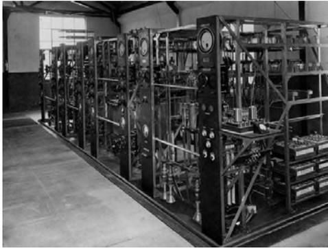
**Fig. 359.-** Transmisor Bodmin. Se pueden observar los cuatro paneles que formaban el transmisor de 12 kW.
