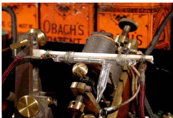
**Fig. 2.-** Receptor con cohesor de limaduras.
