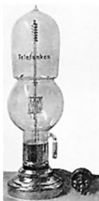
**Fig. 343.-** Válvula Lieben. Se puede apreciar en un costado el pequeño depósito de mercurio.
