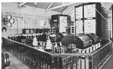
**Fig. 130.-** Transmisor de chispa apagada de 100 kW
