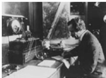
**Fig. 79.-** Operador de la Compañía Marconi recibiendo las señales con el detector magnético.
