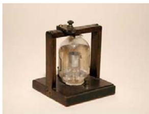
**Fig. 13.**- Válvula que se usó en Poldhu en las demostraciones ante las autoridades navales británicas.
