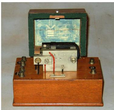
**Fig. 281.** - Amplificador microfónico Brown Tipo V de 1924. Había cuatro tipos y este tipo era para equipos de válvula con una impedancia de entrada y salida de 2000 ohmios. En la tapa se puede ver el esquema. El micrófono de carbón es del tipo balanceado para reducir la distorsión de segundo armónico, y alimenta a un transformador elevador.
