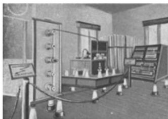
**Fig. 117.-** Chispero de chispa apagada de alta potencia en Nauen
