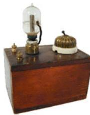
**Fig. 321.-** Receptor con válvula Fleming.
