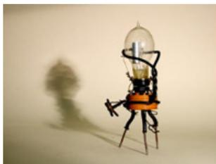
**Fig. 320.-** Válvula experimental que usó Fleming en 1904.
