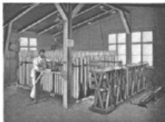
**Fig. 111 (a y b).**-Derecha. Condensador formado por 360 botellas de Leyden. Izquierda. Los cuatro transformadores resonantes para obtener 150.000 voltios. Las dos bobinas de la izquierda son las bobinas para el ajuste de resonancia.
