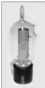
**Fig. 349.-** Válvula Round. Puede verse el apéndice superior con un trozo de asbesto.
