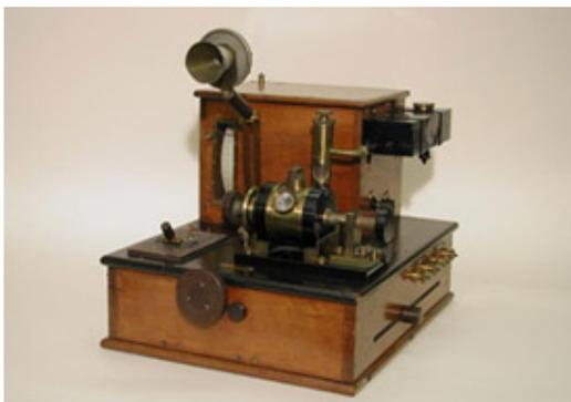
**Fig. 295.-** Transmisor radiotelefónico de arco experimental Marconi.
