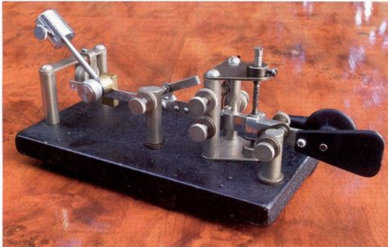
Foto 3. Lionel J-36 con Vari Speed casero en posición lenta
