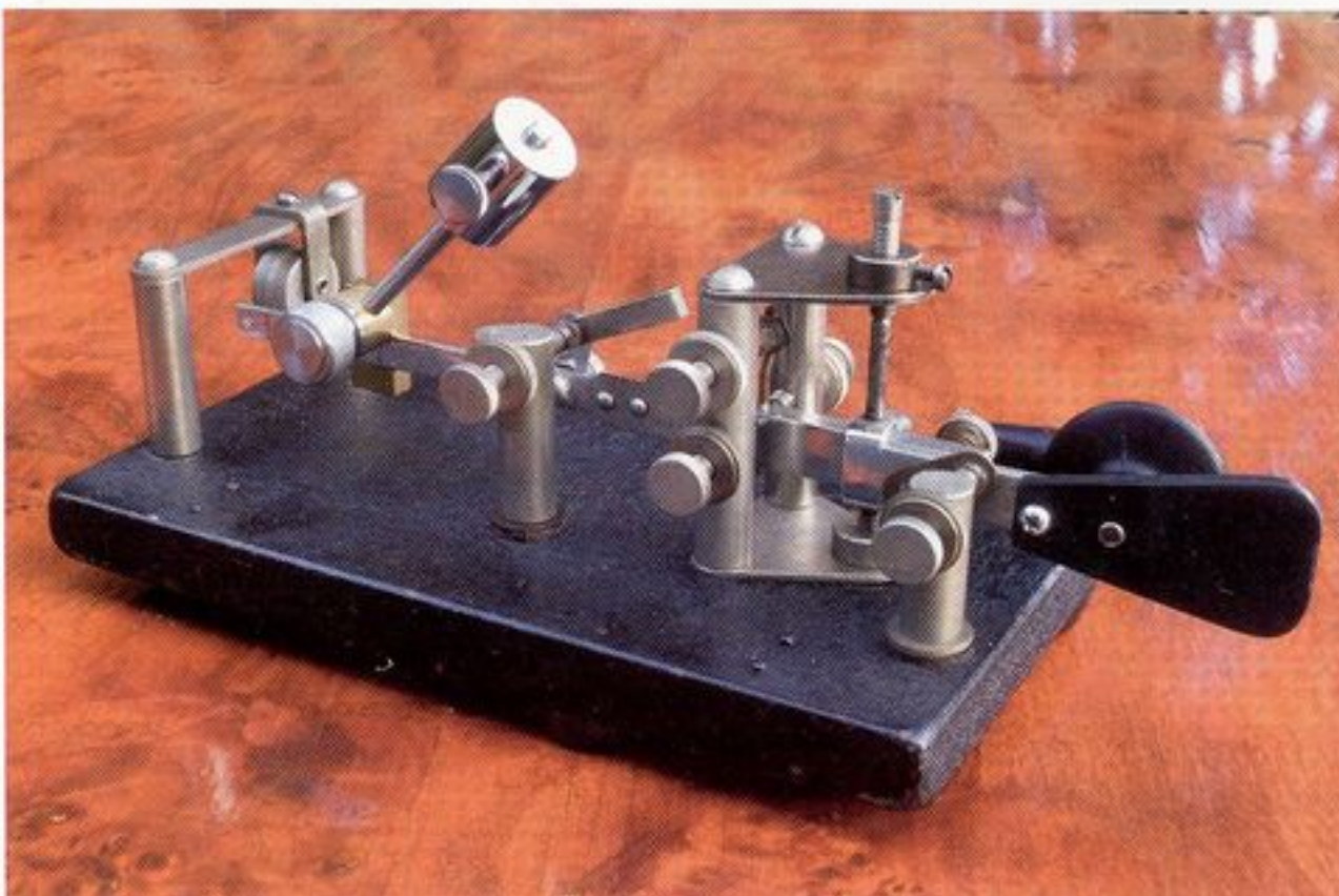
Foto 4. Lionel J-36 con Vari Speed casero en posición rápida
